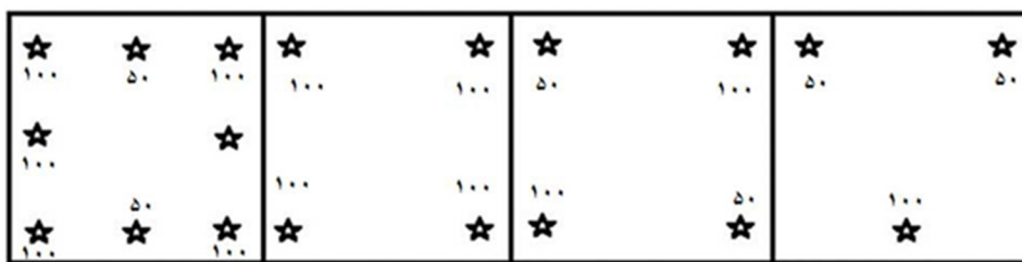
شکل ۱. نحوه آرایش فنرها زیر سطح، عدد نشان دهنده میزان سفتی فنر مورد نظر است
